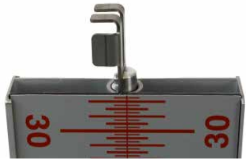
Περιστρεφόμενη κλίμακα με προσαρτημένη βάση για μέτρο (1 βάση για μέτρο στη βαλίτσα)
