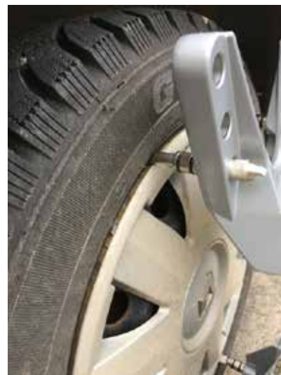
Lado longo da garra com tampas de cubo montadas
