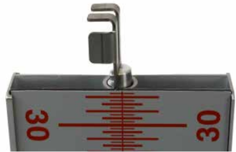
Échelle de mesure pivotante avec support de ruban de mesure inséré (1 support de ruban de mesure dans la mallette)
