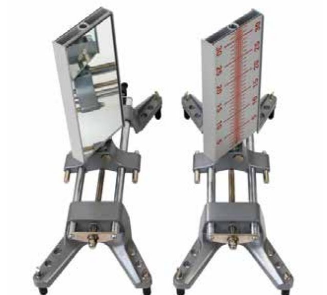
Wielhouder met draaischaal/spiegel SPSK (2 stuks draaischalen SPSK in de koffer)
