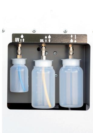
Exakte und variable Öl-Befüllung. Dank einer internen Spülfunktion kann der Öl-Typ sehr einfach gewechselt werden, z. B. von PAG- zu POE-Öl und umgekehrt. Dies ermöglicht den Einsatz an allen Kompressortypen einschließlich Hybrid- und Elektrofahrzeugen.
