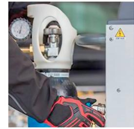
Die in der Gerätesoftware integrierte Stickstoff-/Formiergasprüfung gewährleistet eine verbindliche Dokumentation gegenüber dem Endkunden.
